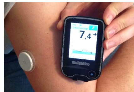
Bild: Principen bakom glukosmätare bygger på en enzymatisk reaktion där glukosoxidas förbrukar glukos och genererar en elektrokemisk signal som mätaren registrerar.
